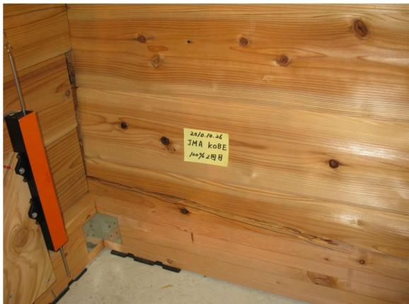
写真-6.3.6 直交壁ログ材の割れ
