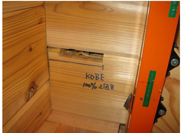
写真-6.3.5 ノッチ部水平ずれ
