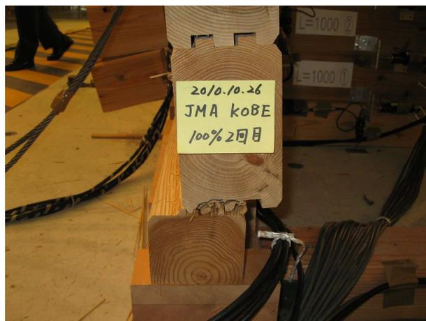
写真-6.3.8 直交壁の水平ずれ
