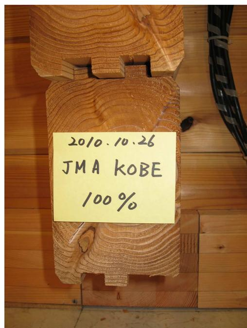
写真-6.2.3 ノッチ部水平ずれ
