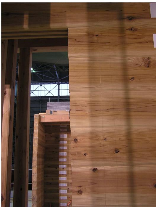
写真-6.3.1 ログ材間の水平ずれ
