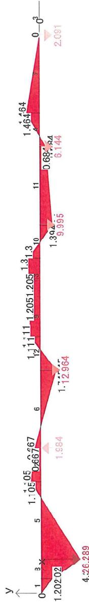
プロットビュー - 静的荷重条件: 荷重条件名 1 Mz' (kN-m)
