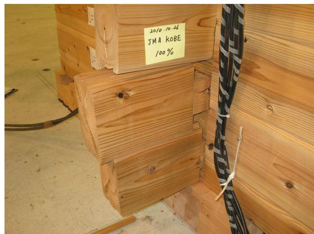
写真-6.2.2 ノッチ部水平ずれ
