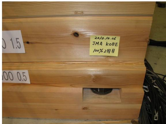
写真-6.3.7 直交壁ログ材の割れ
