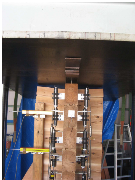
写真－5.1.30 試験体の状況 最大荷重時 ・ 加力部
