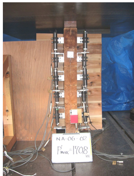
写真－5.1.14 試験体の状況 試験時最大荷重時 ・ 全景
