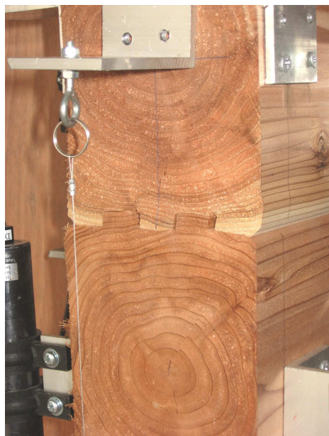
写真－5.1.15 試験体の状況 試験時最大荷重時 ・ ログ材のさねのめり込み
