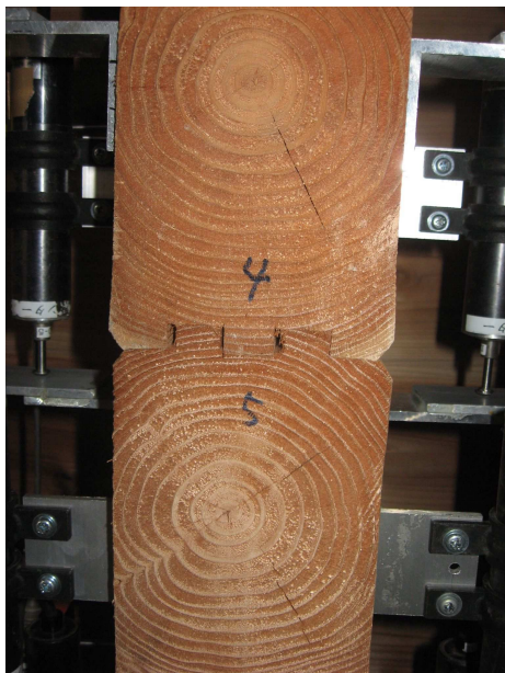
写真－5.1.38 試験体の状況 最大荷重時 ・ ログ材のさねのめり込み
