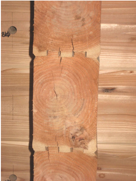
写真－5.1.17 試験体の状況 試験時最大荷重時 ・ ログ材のさねのめり込み
