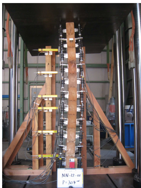
写真－5.1.20 試験体の状況 長期軸力時 ・ 全景
