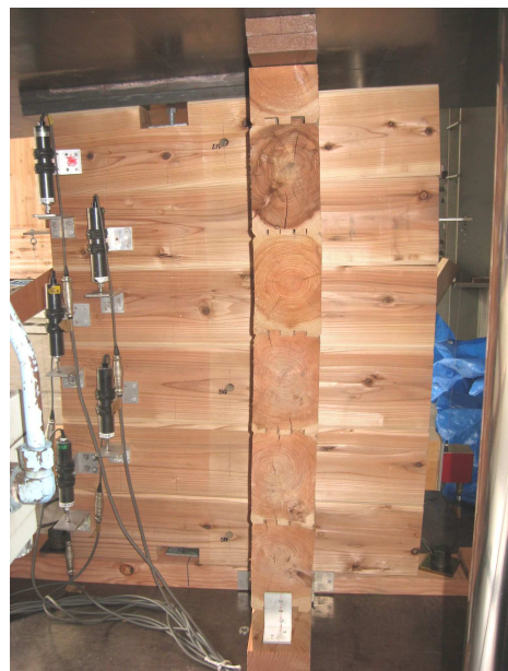
写真－5.1.16 試験体の状況 試験時最大荷重時 ・ 直交壁のたわみ
