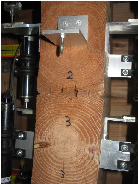
写真－5.1.36 試験体の状況 最大荷重時 ・ ログ材のさねのめり込み
