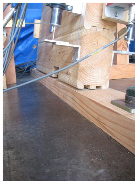
写真－5.1.23 試験体の状況 最大荷重時 ・ 最下段ログ材
