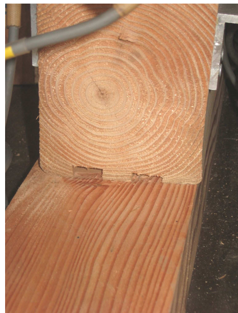
写真－5.1.8 試験体の状況 最大荷重時 ・ 最下段ログ材さね部のめり込み
