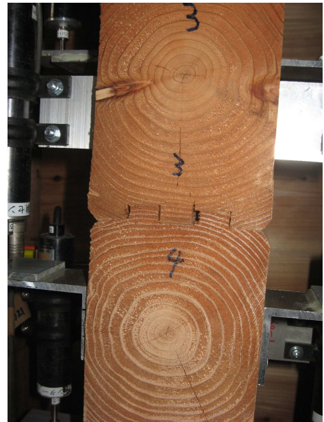
写真－5.1.37 試験体の状況 最大荷重時 ・ ログ材のさねのめり込み
