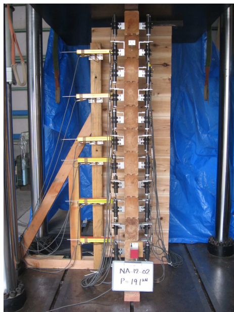
写真－5.1.32 試験体の状況 長期軸力時 ・ 全景
