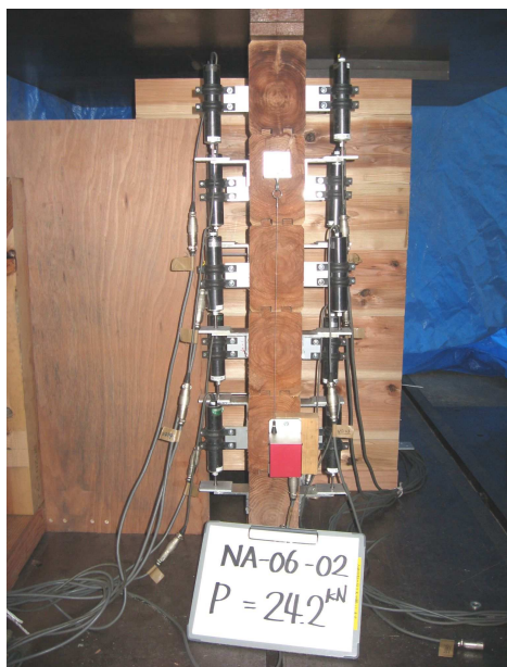
写真－5.1.13 試験体の状況 長期軸力時 ・ 全景
