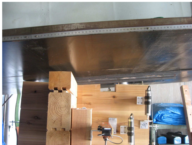
写真－5.1.31 試験体の状況 最大荷重時 ・ 加力部
