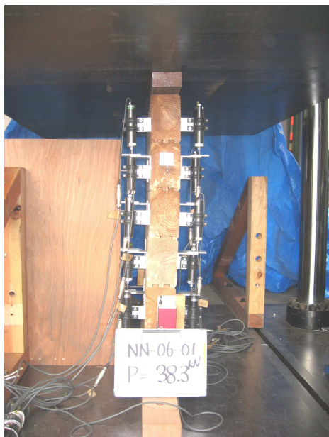
写真－5.1.1 試験体の状況 長期軸力時 ・ 全景
