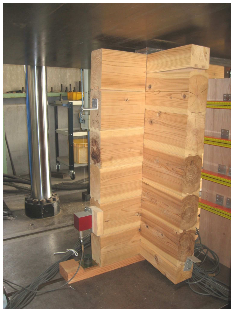
写真－5.1.11 試験体の状況 試験時最大荷重時 ・ 全景
