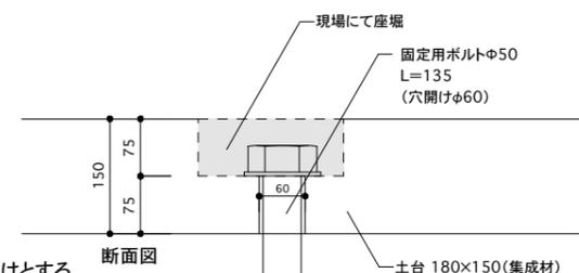
土台アンカーボルト穴詳細図 S=1:10
