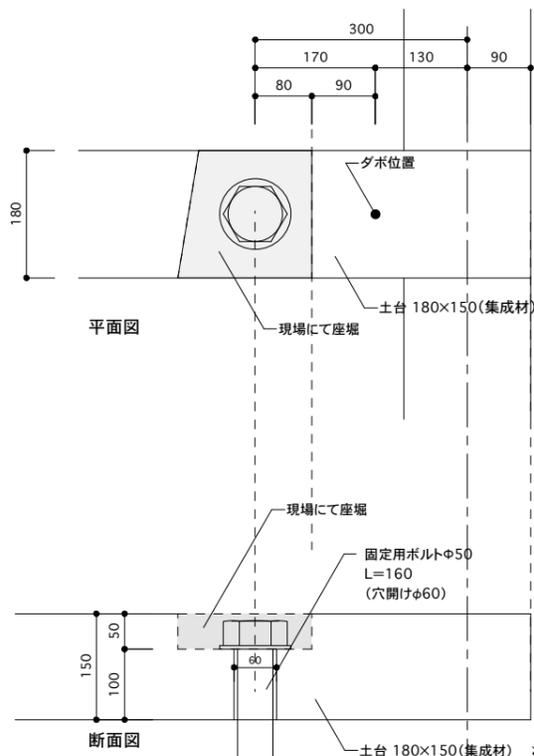
土台アンカーボルト穴詳細図 S=1:10
