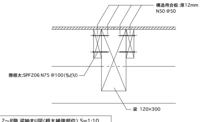
2~R階 梁納まり図(根太補強部位) S=1:10
