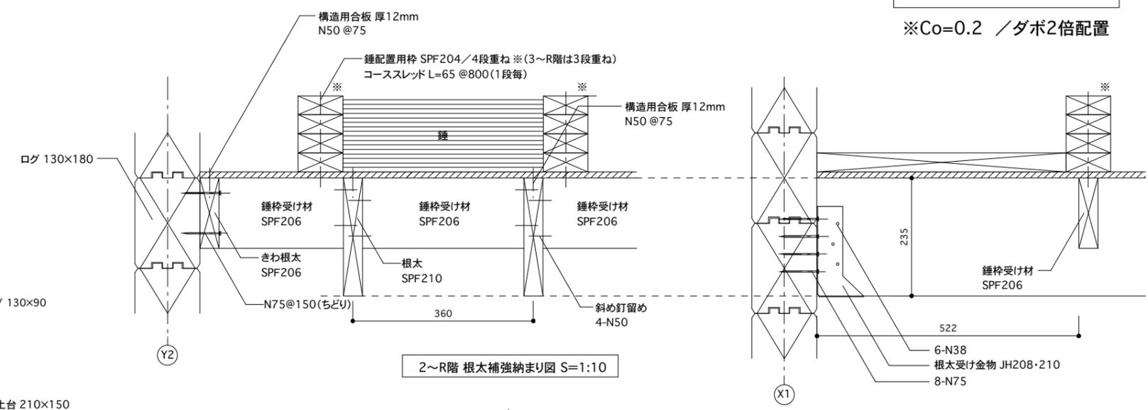
2~R階 根太補強納まり図 S=1:10
